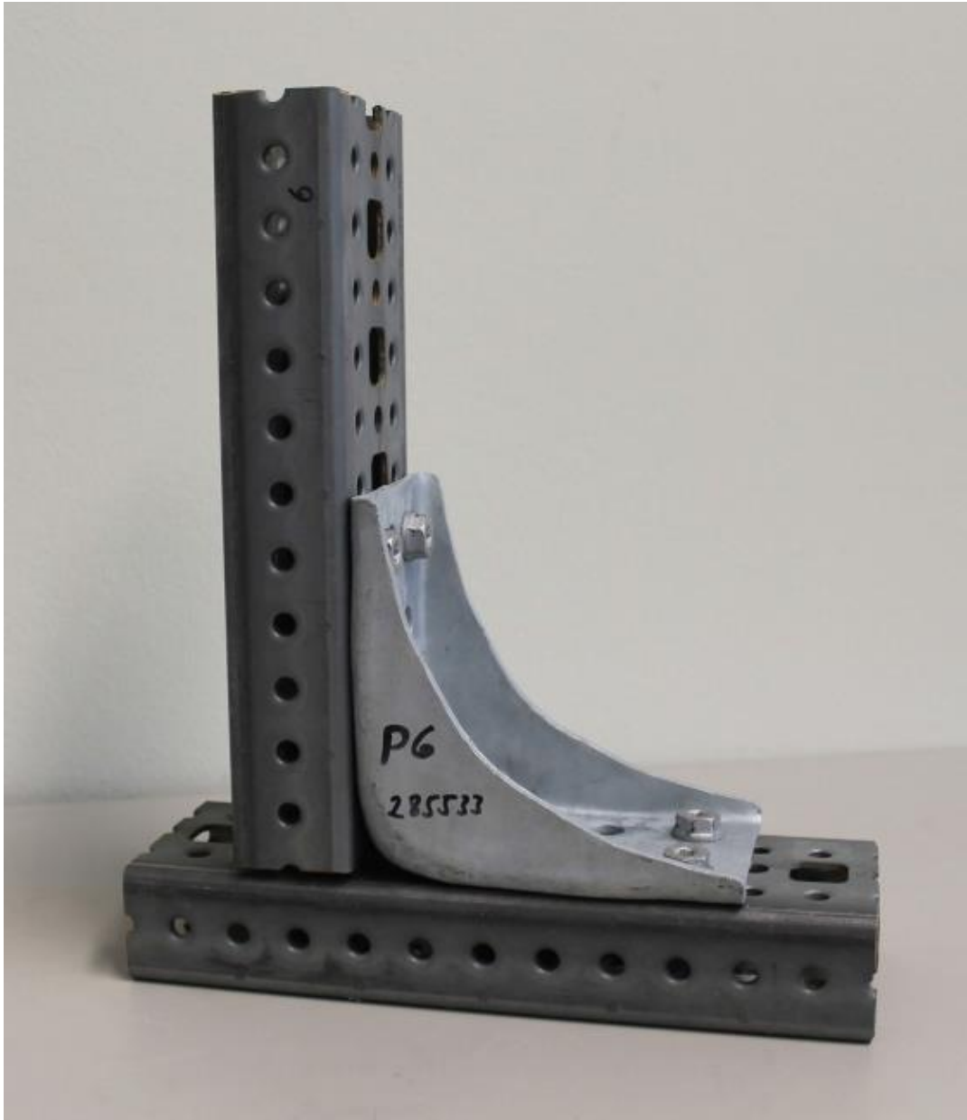
Foto 6 (Prüfaufbau 2 (Muster 6) Repräsentativ für alle (Muster 4 – 6) mit Schwefeldioxyd / 24 h vorkonditionierten Muster. Photo 6 (Test setup 2 (sample 6) Representative for all (sample 4 – 6) with Sulfur dioxide / 24 h preconditioned samples
