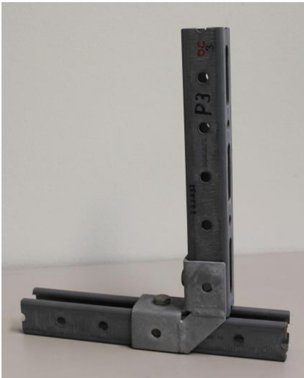
Foto 4 (Prüfaufbau 1 (Muster 3) Repräsentativ für alle (Muster 1 – 3) mit Schwefeldioxyd / 24 h vorkonditionierten Muster. Photo 4 (Test setup 1 (sample 3) Representative for all (sample 1 – 3) with Sulfur dioxide / 24 h preconditioned samples.
