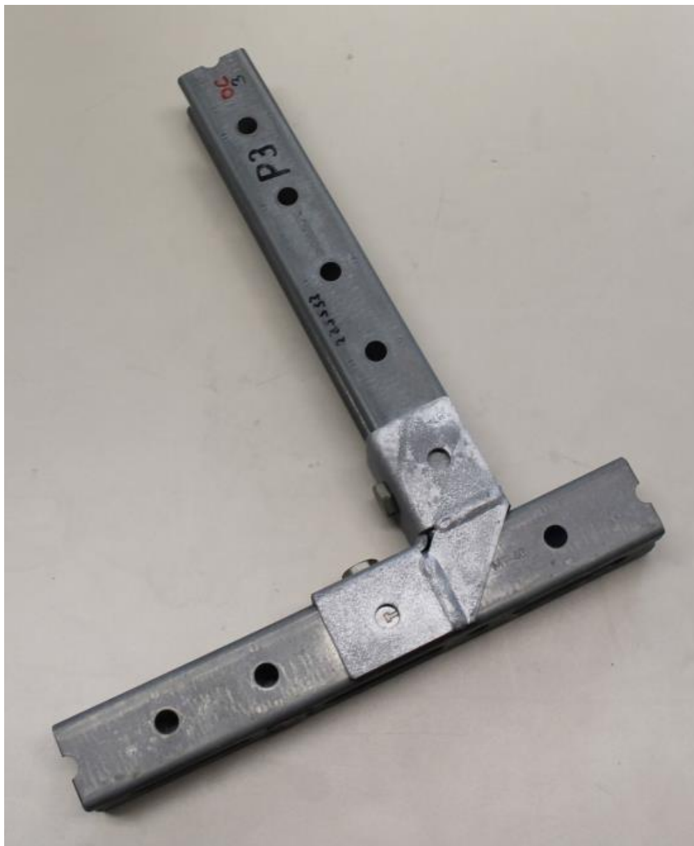
Foto 3 (Prüfaufbau 1 (Muster 3) Repräsentativ für alle (Muster 1 – 3) mit Schwefeldioxyd / 24 h vorkonditionierten Muster. Photo 3 (Test setup 1 (sample 3) Representative for all (sample 1 – 3) with Sulfur dioxide / 24 h preconditioned samples.
