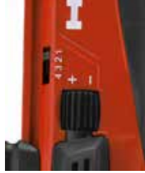
Rad für Einstellung der Setzenergie: Einstellung 1: Minimale Energie Einstellung 4: Maximale Energie
