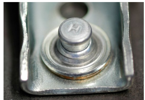
Világosan látható dugattyújelölés a felső alátétben
