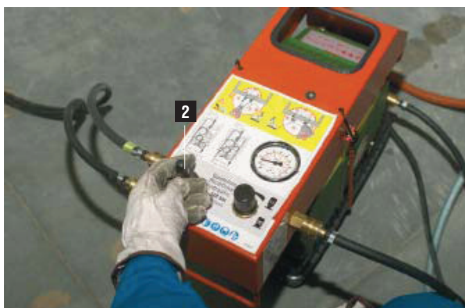
2 Regelventiel voor voortbewegingsrichting
