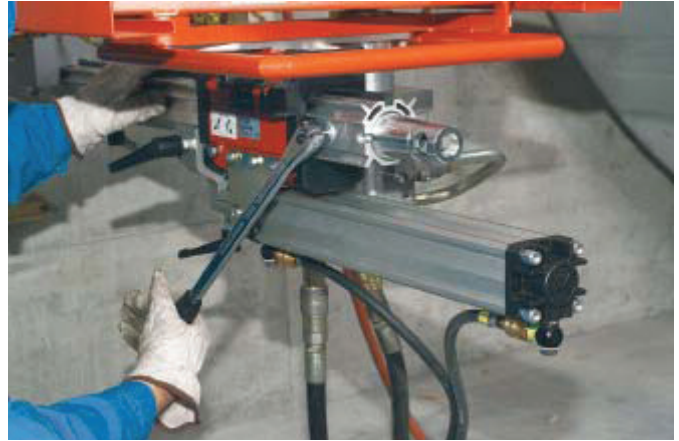
Verbindingskegel insteken en met excentriekpen vastklemmen
