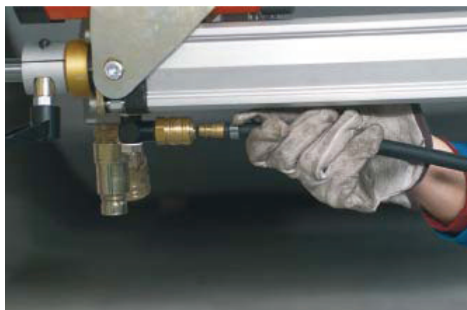
Persluchtleidingen aan cilinder aansluiten
