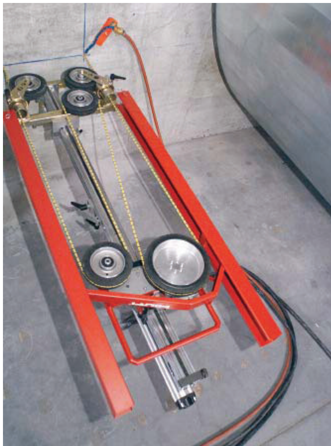
Persluchtleidingen aan cilinder aansluiten
