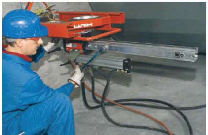
Opslaguitbreiding opzetten en met excentriekpen vastklemmen
