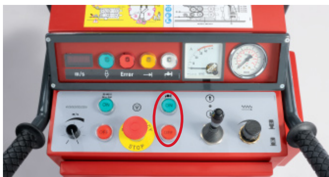
Ouverture/coupage du circuit d'eau de refroidissement sur le pupitre de commande
