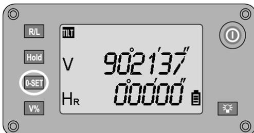
水平目盛盤の読みは、0-SETボタンを押していつでもゼロに設定することができるので、基準ポイントまたはゼロポイントを水平目盛盤に設定することができます。
